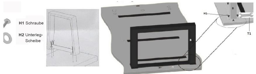
Mittels der Unterlegscheiben und den Schrauben montieren Sie die Füße an die Tischplatte.
