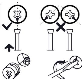
Avant de raccorder les excentriques, bien s'assurer que la position de départ est correcte avant d'insérer le boulon de connection.
